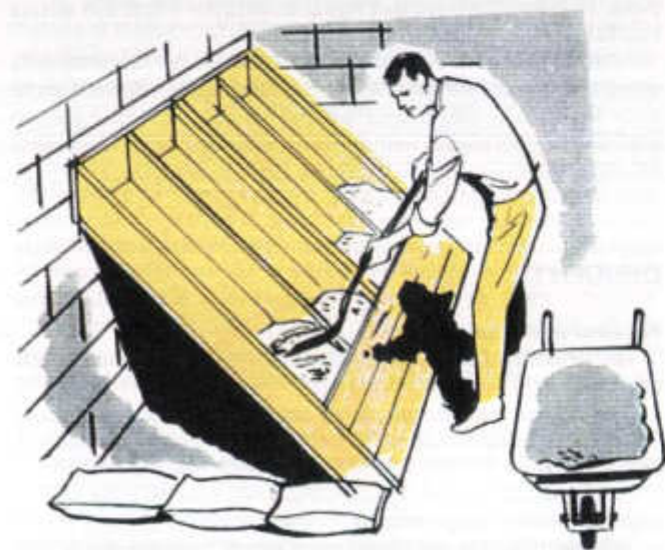
Tipo di rifugio a piano inclinato lungo i muri ad angolo della casa, la cui entrata viene chiusa con sacchi di terra o di sabbia. A sinistra, un rifugio d'emergenza con scavo d'una fossa: piano inclinato di tavole o porte coperte della stessa terra dello scavo.
